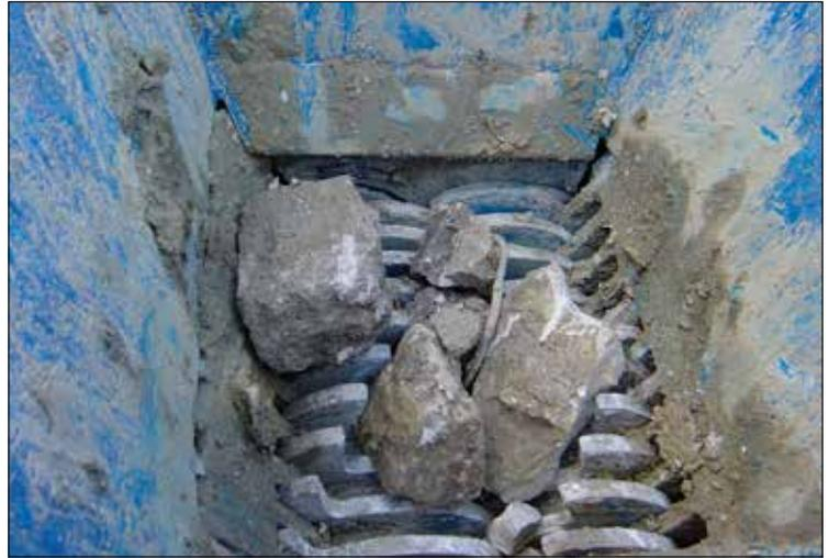
Due alberi rotanti muniti di coltelli in acciaio speciale durante la lavorazione.
