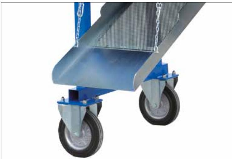
In dotazione tramoggia di scarico a un piano in lamina forata da 8 mm. A richiesta vaglio vibrante a due piani con 3 selezioni granulometriche.
