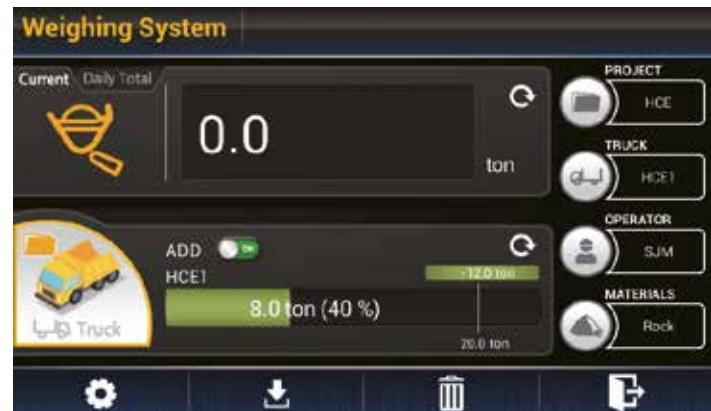
Visoko precizan **automatski/ručni kumulativni sustav vaganja** pomaže vam da učinkovitije upravljate proizvodnjom u bilo kojem okruženju. Za maksimalnu preciznost, na ekranu se prikazuju ikone pogrešaka vaganja i dvobojni indikator vrijednosti težine.
