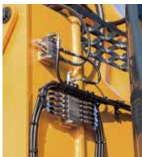
Uz opcionalni **sustav automatskog podmazivanja**, mast se prema potrebi automatski nanosi na mesta podmazivanja. Osigurano je ispravno doziranje i jednoliko nanošenje maziva, čime se smanjuje potrošnja masti i uklanja otpad.
