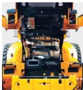
**Nagnuta hauba motora potpuno se uvlači** i može se **otvoriti elektronski** za lakši pristup motoru i rashladnoj prostoriji. Motorni prostor je projektiran tako da sprječi mogućnost požara uzrokovanih dotokom stranih materijala.
