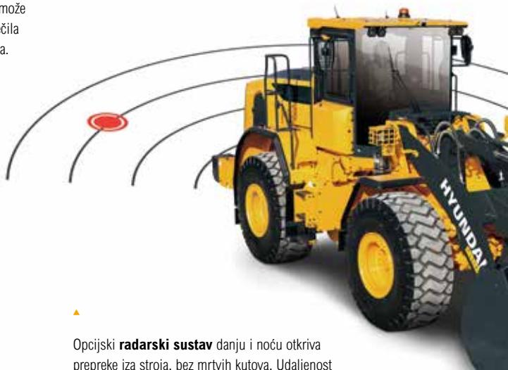
Opcijski **radarski sustav** danju i noću otkriva prepreke iza stroja, bez mrtvih kutova. Udaljenost između prepreke i utovarivača prikazuje se na monitoru.
